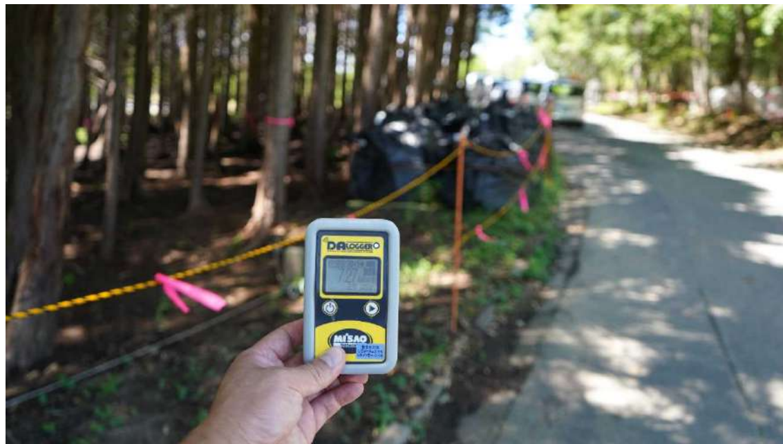
図2 除染中の森のキワ(大熊町の特定復興再生拠点内)。地上1 m高で7.27 \mu Sv/h。撮影は2021年4月。現在でも除染作業は続けられている。
